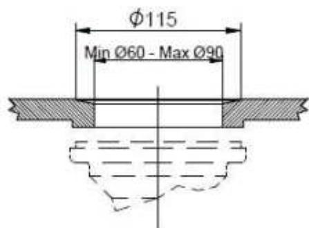
FORO SCARICO / DRAIN HOLE
